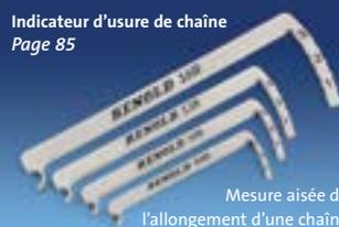
Mesure aisée de l'allongement d'une chaîne
