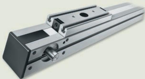
Disponible aussi comme module miniature : le module linéaire avec guidage interne par galets et avec entraînement par courroie crantée – profilé porteur à rigidité propre en aluminium – vaste gamme d'accessoires
