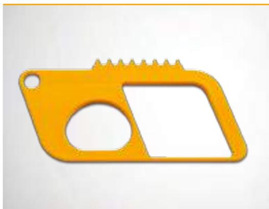
Permet d'identifier rapidement et facilement l'usure d'une courroie : positionner l'appareil sur les stries de la courroie au repos pour contrôler l'usure de son profil.
